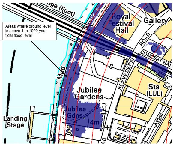
FIGURE H 2: EXAMPLE OF RAISED GROUND ALONG RIVER'S EDGE (HIGHLIGHTED IN BLUE)
